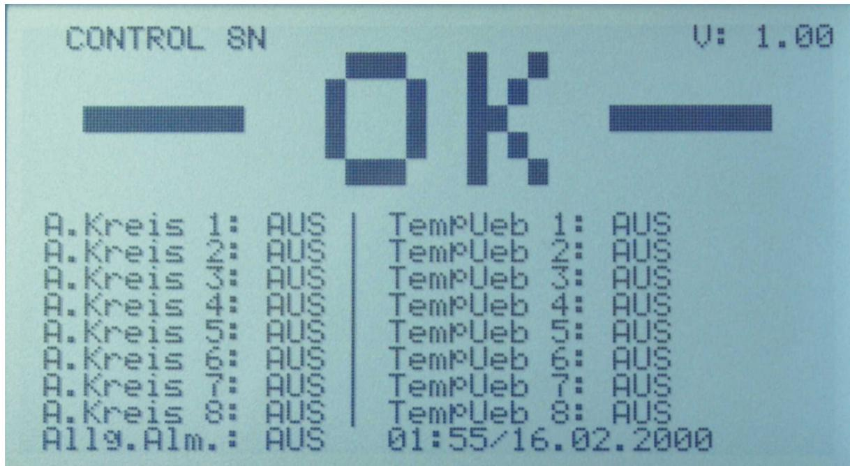
Meldet eine Alarmquelle (Alarmkreis oder Temperatursensor) einen Fehler Wird dies durch die Anzeige ALARM angezeigt.
